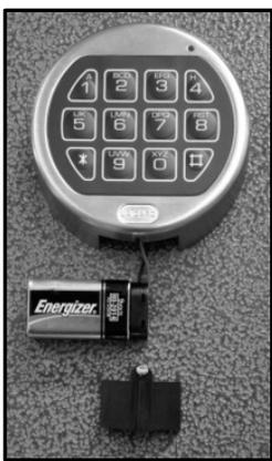
4. Sujete la palanca temporal como se muestra y sauvemente rotar hacia la derecha.
